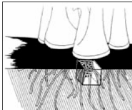
Figure 9. Prélèvement des racines à l'intérieur du trou de dimension standard 20*20*20 cm (source : Carlier et al., 2002)
